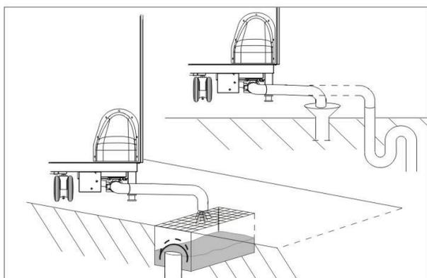
Учитывать параметры водостока. В течение короткого промежутка времени объем откачки воды из парогенератора может составлять 0,7 л/сек.
